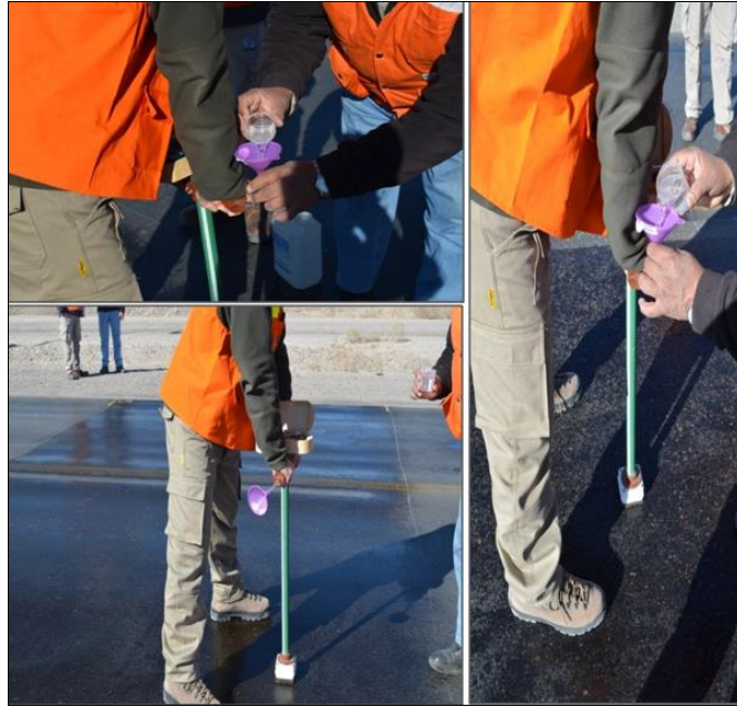
Figura 10. Procedimiento de medición de conductividad sobre pavimento
