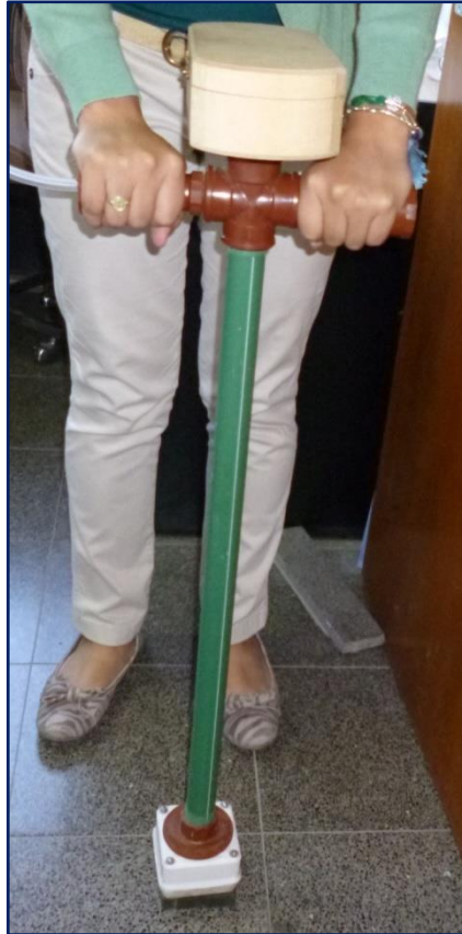
Figura 1. Aparato de medición del residuo salino (MRS) desarrollado en el proyecto
