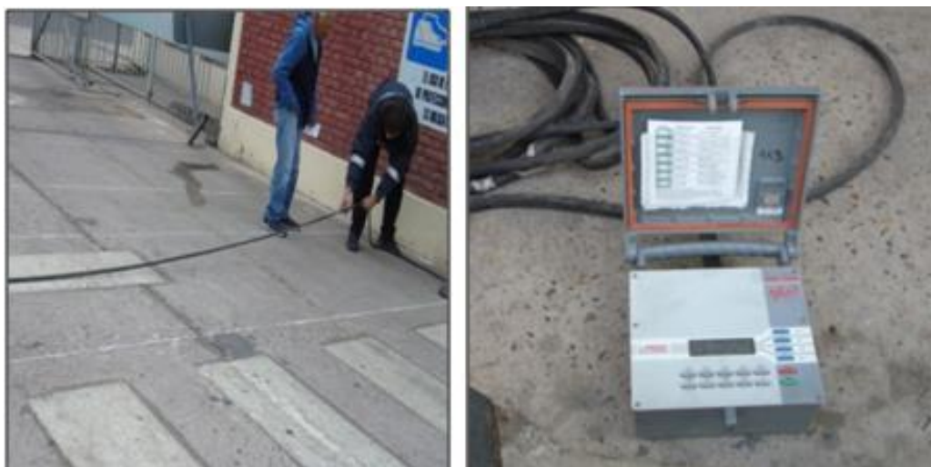
Figura 6. Contador de tránsito, mediciones en playón del 9° Distrito San Juan, DNV
